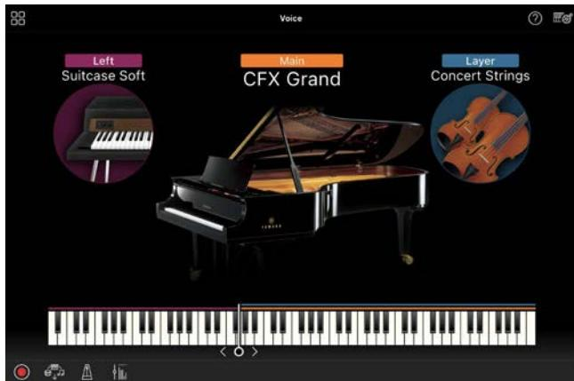
È possibile limitarsi a suonare una sola voce (Main), ma anche sovrapporre una voce diversa (parte Layer) alla parte Main. È anche possibile suonare una voce diversa nella sezione sinistra della tastiera attivando la parte Left.
