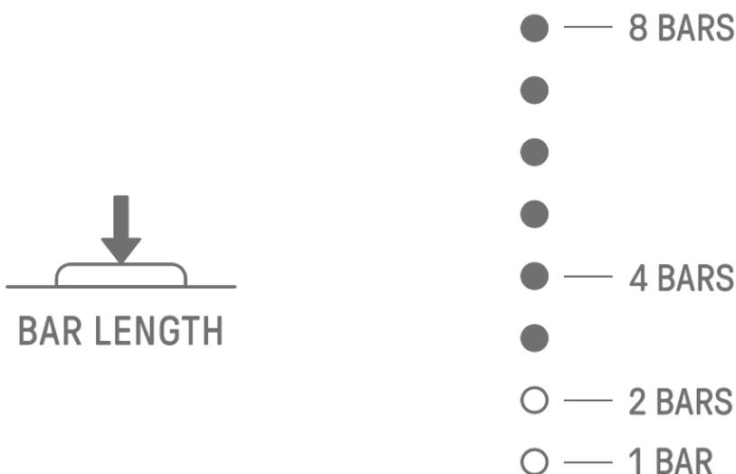
Maintenez la touche [BAR LENGTH] enfoncée et tournez un bouton de piste de synthétiseur ou le bouton [SAMPLER] pour régler la longueur du motif par pas de 1–128. Appuyez sur un bouton de piste de synthétiseur ou sur le bouton [SAMPLER] et tournez-le pour modifier la valeur par incréments d'une mesure (16 pas). Le nombre de mesures s'affiche sur l'indicateur de niveau global et le nombre de pas sur les touches de batterie.
