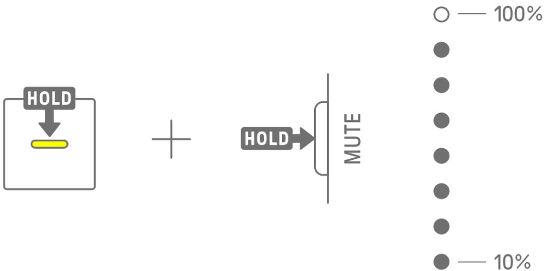
Maintenez plusieurs touches de batterie enfoncées et appuyez sur la touche [MUTE] pour réduire la probabilité de déclenchement de ces pas d'un niveau.
