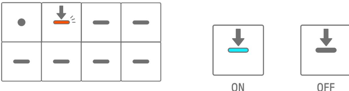
Pour modifier la longueur des notes du pas sélectionné, maintenez une touche de batterie activée enfoncée et tournez le bouton [ALL]. La longueur de la note est indiquée par les touches de batterie et l'indicateur de niveau global.
